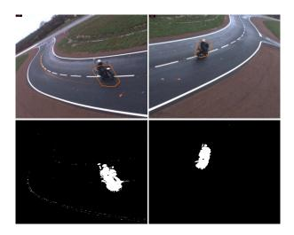
FIGURE 5 – Gauche : entrée de courbe. Droite : sortie de courbe. Enveloppe estimée et trajectoire de la moto. Haut : images couleur. Bas : images binaires d'avant-plan.
