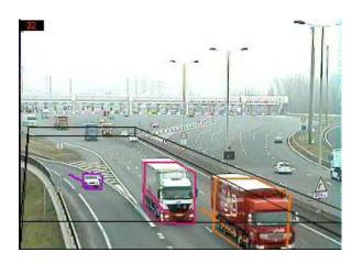
FIGURE 6 – Enveloppe estimée et trajectoire de camions et voitures sur autoroute (la zone de suivi est délimitée par les lignes noires).
