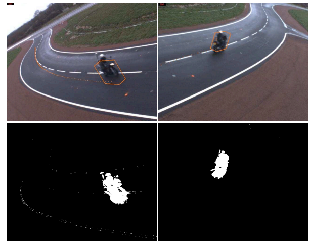
FIGURE 5 – Gauche : entrée de courbe. Droite : sortie de courbe. Enveloppe estimée et trajectoire de la moto. Haut : images couleur. Bas : images binaires d'avant-plan.
