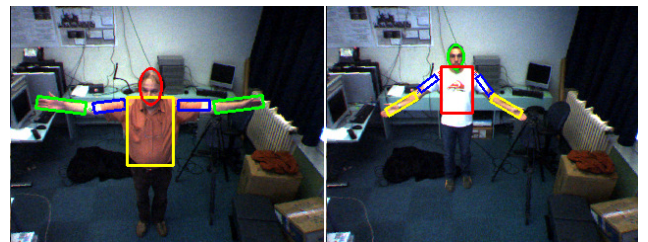
Figure 7 : exemple de résultats d'initialisation automatique dans des conditions variables : éloignement à la caméra et postures différentes.
