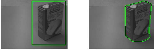
FIGURE 5 – Segmentation d’un objet par un snake : positions initiales et finales.
