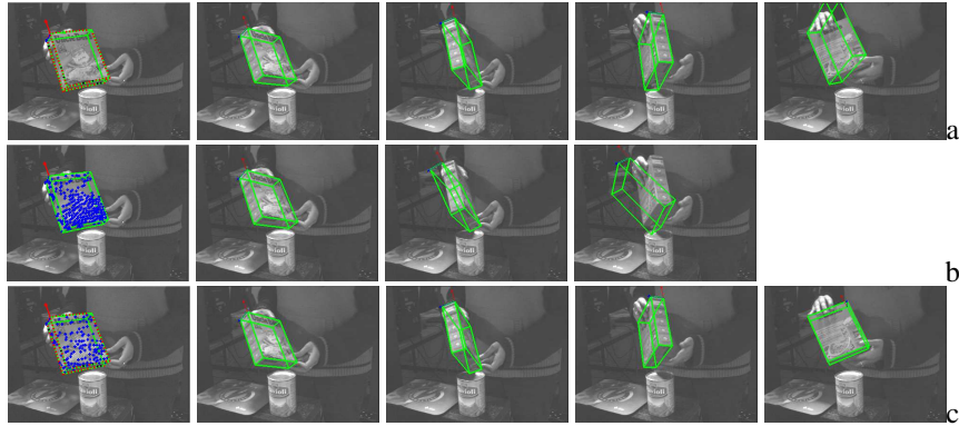
Figure 9. Suivi hybride (Pressigout et al., 2006). Images pour (a) : suivi 3D basé contours, (b) : suivi 2D basé sur l'apparence, (c) : suivi hybride. Seul le suivi hybride permet de suivre correctement l'objet sur toute la séquence malgré les spécularités et les modifications d'aspect de l'objet
