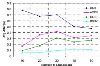
Figure 4. Gigue, en fonction de la charge
