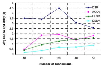
Figure 3. Délai, en fonction de la charge
