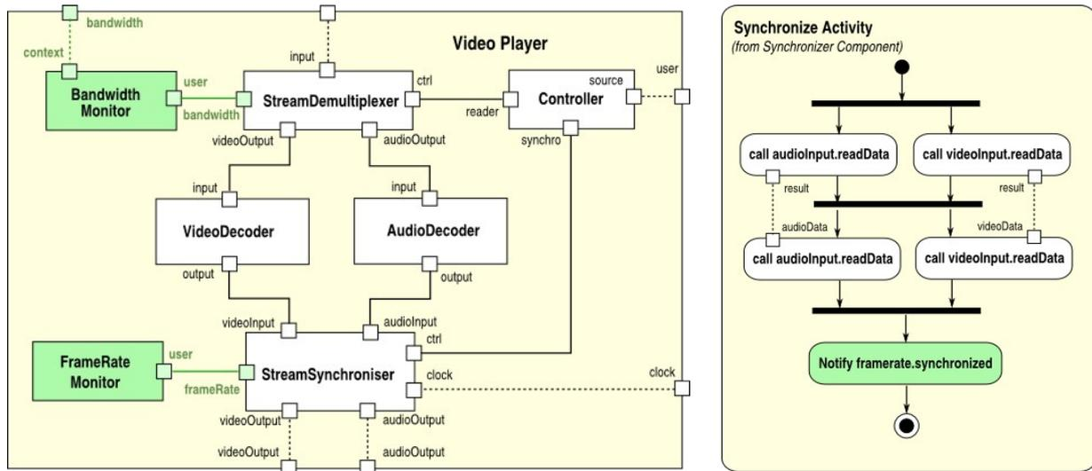
Figure 4: Intégrations structurelle et comportementale de sondes extra-fonctionnelles
