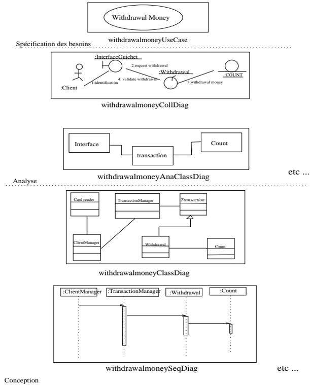
**Figure 5. Processus traditionnel de développement**
