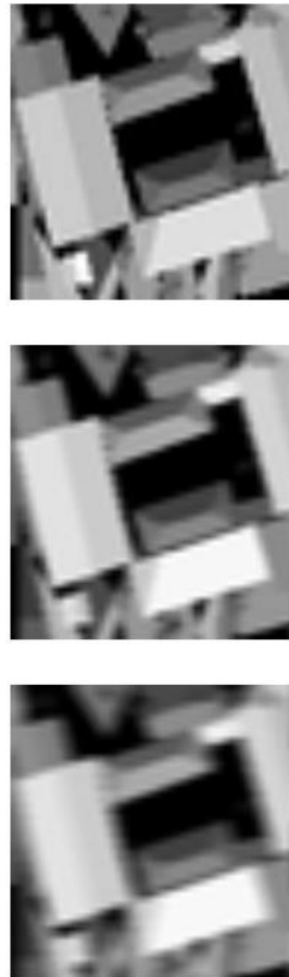
Figure 13. Simulation de l'effet de filé pour différents temps de pose et une vitesse de déplacement du capteur de 100 \text{ m}\cdot\text{s}^{-1} : image instantanée (haut), 1/100^{\text{ème}} s (centre), 1/50^{\text{ème}} s (bas).
