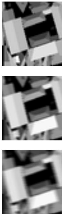
Figure 13. Simulation de l'effet de filé pour différents temps de pose et une vitesse de déplacement du capteur de 100 \text{ m}\cdot\text{s}^{-1} : image instantanée (haut), 1/100^{\text{ème}} s (centre), 1/50^{\text{ème}} s (bas).
