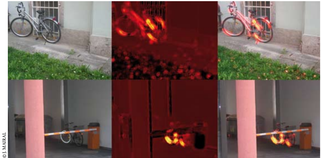
Fig. 3 : Les deux images de gauche contiennent entre autres une bicyclette. Grâce à la technique de classification que nous avons mis au point, l'ordinateur est capable de classer les pixels qu'il suppose appartenir à une bicyclette avec une certaine confiance (du rouge au jaune selon que le degré de confiance est élevé ou faible).
