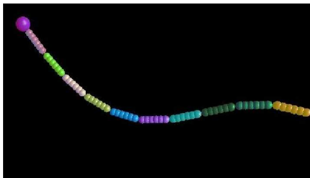
Pendule : pendule articulé composé de 12 barres rigides de 6 sphères chacunes
