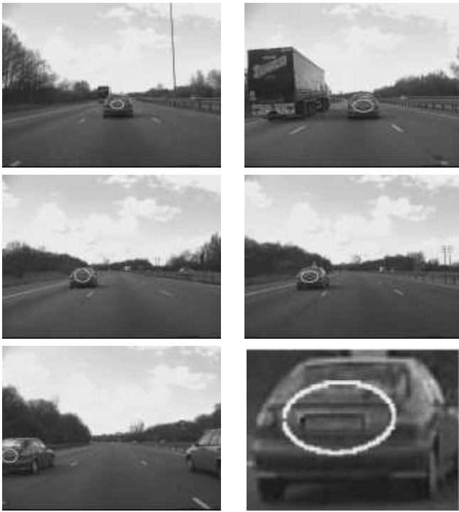
FIG. 5 – Résultat du suivi de la plaque : images 1, 187, 347, 417, 520 de la séquence, et un zoom fait sur l’image 417.
