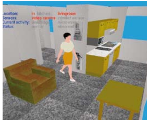
Fig. 4 et 5 : à gauche, la personne représentée est détectée en trois dimensions par son mouvement et son gabarit. L'image de droite correspond à l'interprétation de celle de gauche : la personne réelle est représentée par un modèle 3D de personne et replacée dans un modèle 3D du lieu observé par les caméras.
