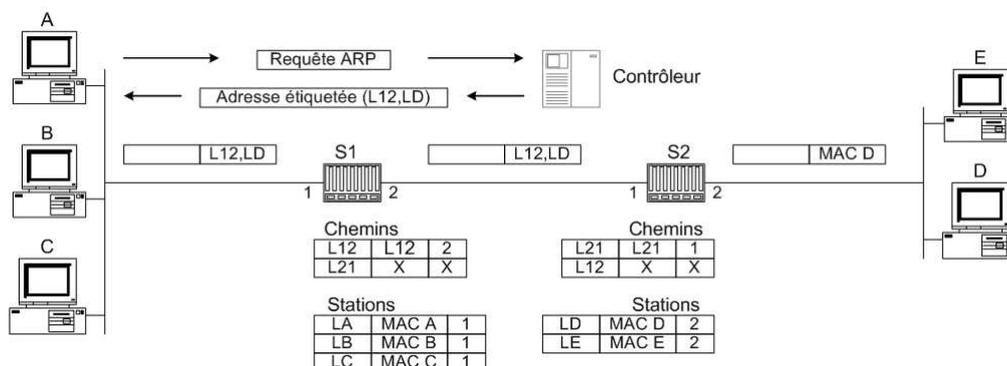
Figure 2 – Acheminement des trames dans *LaidaNet*
