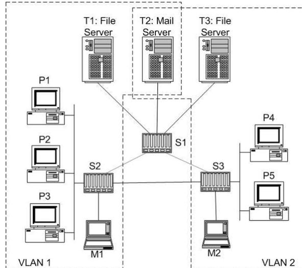
Figure 4 – Exemple de VLAN dans *LaidaNet*
