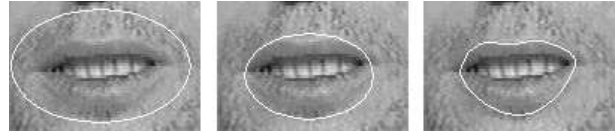
FIG. 6 - Extraction du contour de la bouche. Initialisation et résultats obtenus avec une, puis cinq harmoniques pour le contour supérieur. Le contour inférieur est décrit par une seule harmonique.
