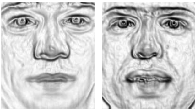
FIG. 2 - Inverse du résultats sur deux visages différents du calcul de la valeur cumulée de la norme du gradient spatio-temporel sur une séquence d'images.
