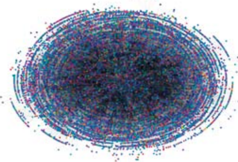
Fig. 1 : Dans un réseau pair-à-pair, chaque ordinateur est à la fois client et serveur. Une fois connecté au réseau, via un logiciel commun, chacun peut participer aux tâches communes, par exemple échanger des fichiers de musique. Sur ce graphique, les points représentent des machines autonomes, et les lignes les communications entre ces machines.
