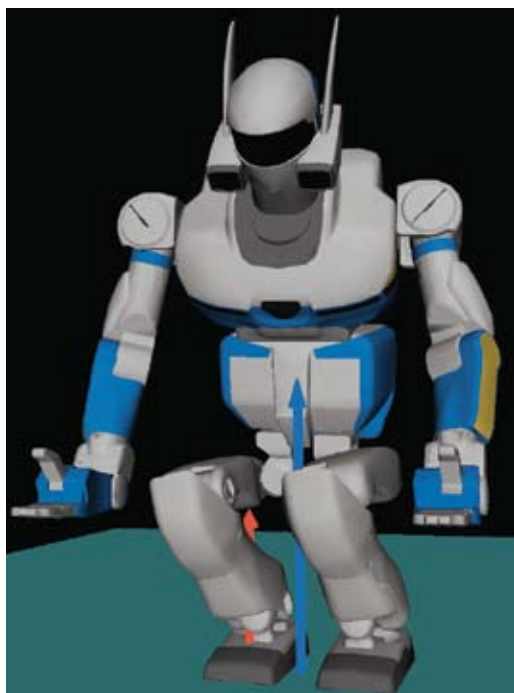
Fig. 2 : Cette image de robot marcheur, HRP-2 (conçu et réalisé par l'AIST et Kawada Industries) est le fruit d'une simulation réalisée grâce à la boîte à outils logiciels ( Humanoid Motion Analysis and Simulation (HuManS) mise au point par l'équipe BIPOP de l'INRIA Grenoble. Utilisé par plusieurs équipes dans le monde, HuManS permet de modéliser, contrôler et analyser le mouvement d'un humanoïde.
