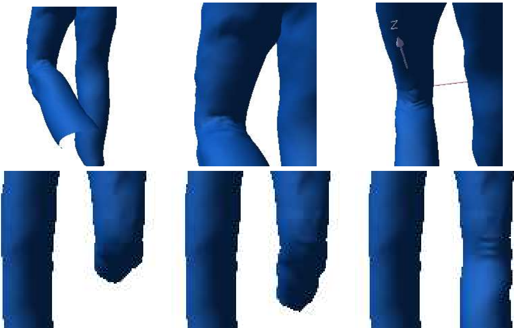
FIG. 12 – Illustration de notre outil de création de plis sur un pantalon virtuel. La ligne du haut montre l'arrière d'un pantalon où les plis sont créés par deux séries de plis superposées. La ligne du bas montre l'avant d'un pantalon où une série de rides est disposée sur la jambe de droite. On peut constater la différence avec la jambe de gauche, dépourvue de plis.
