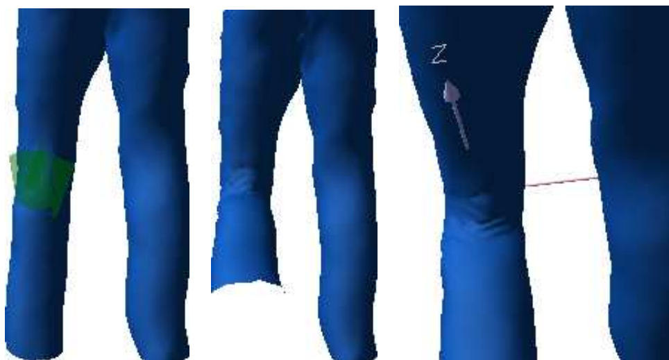
FIG. 9 – Superposition de plusieurs séries de rides sur l'arrière du genou d'un pantalon virtuel. Lorsque le genou se plie, les rides apparaissent.
