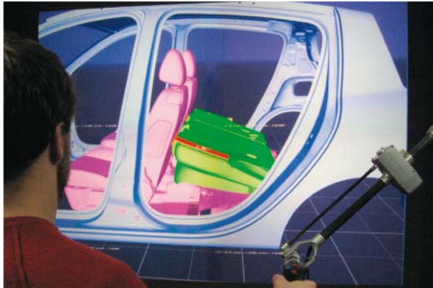
Fig. 2 : Deux ingénieurs coopèrent à distance pour concevoir le montage de la banquette arrière d'un véhicule (informations fournies par Renault): ils disposent chacun d'un bras à retour d'effort (à droite sur les photos).
