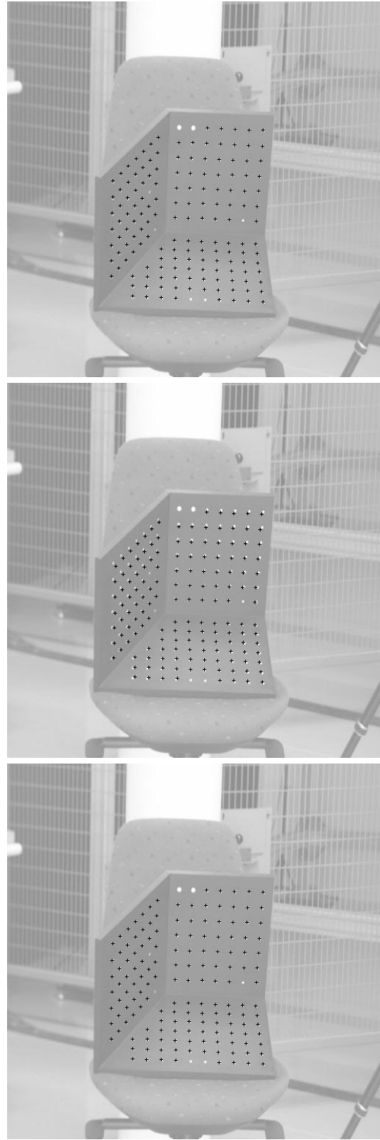
FIG. 9 – Les points réprojétés sur l'image originale par (a) la méthode algébrique (b) la méthode linéaire 24 \times 24 (c) la méthode linéaire non linéairement optimisée 24 \times 24 .
