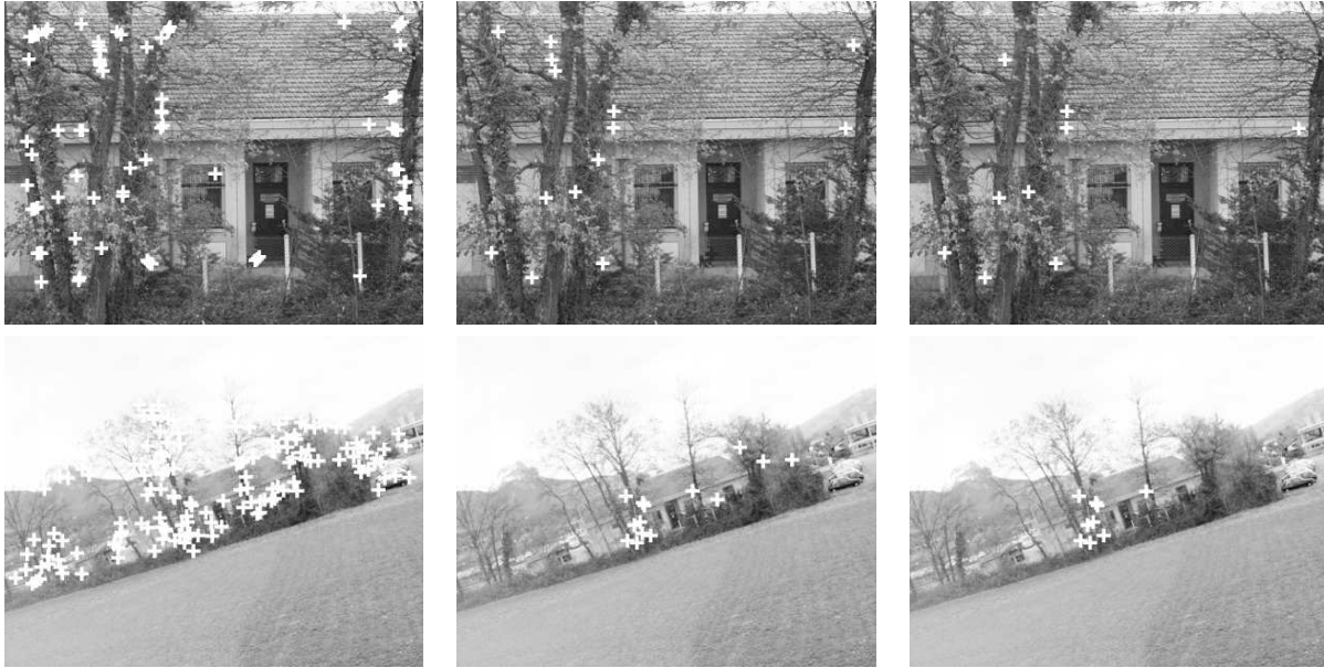
FIG. 7 – Appariement robuste : Il y a 89 points détectés dans l'image du haut et 126 dans l'image du bas. Après la phase I il y a 14 points appariés. Après la phase II il reste 9 appariements, tous corrects. Le facteur d'échelle estimé est de 4.9, et l'angle de rotation de 19^\circ .
