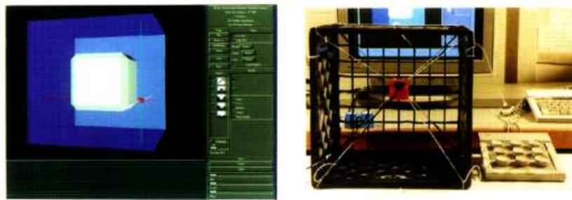
Figure 2.2. L'interface du système de [Galyean et Hughes, 1991] et la boîte offrant le retour haptique passif sur le Polhemus Isotrak.
