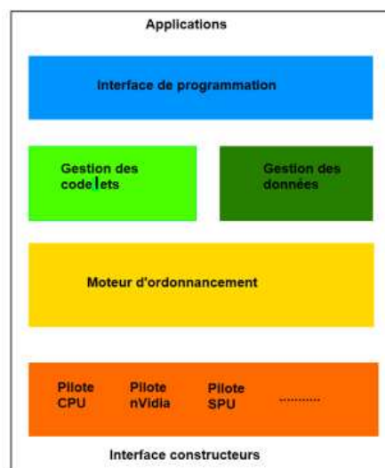
FIGURE 2.1 – Pile Logicielle de StarPU
