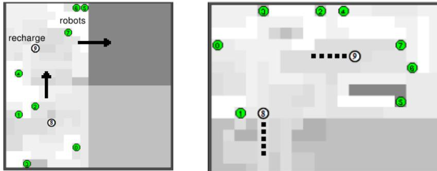
FIGURE 2.4 – Illustration du modèle de positionnement dynamique : 2 recharges mobiles suivent l'évolution de 2 flottilles réalisant une tâche de patrouille, cf. [80]. Lorsque les flottilles changent de région, les recharges sont entraînées par effet d'attraction et tendent à rester à leur barycentre.
