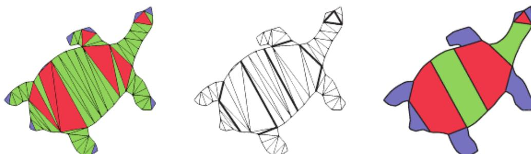
FIGURE 2 – A gauche, la triangulation de Delaunay construite à partir d'un échantillonnage du contour. Trois types de triangles sont distingués : les triangles de jonction (rouge), les triangles de lien (orange) et les triangles terminaux (bleus). Au milieu, les cordes du CSP étendu sont en gras. A droite, la segmentation induite.
