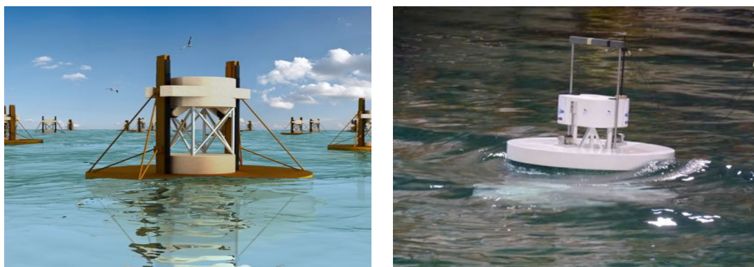
FIGURE 1.4 – Modélisation du houlogénérateur « Bilboquet » – L'expérimentation in virtuo d'une maquette virtuelle dans le cadre de la conception d'un système, comme illustré à gauche, peut permettre d'identifier les paramètres sensibles du système. La simulation ne vise pas à remplacer les essais réels, ici sur un modèle réduit en bassin (à droite), mais intervient en complément de ceux-ci dans le but de limiter les plages de paramètres à tester. Source : Images CERVVAL, http://www.cervval.com
