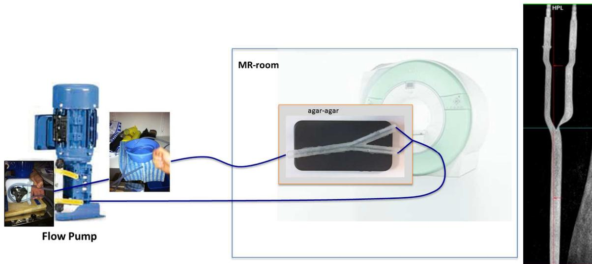
**Figure 11. Circuit de test sur fantôme de sténose.** La pompe à galets non-IRM compatible est placée à l'extérieur de l'IRM et reliée au fantôme par un système de tuyaux dans lesquels circulent un liquide de viscosité similaire au sang. A droite : acquisition en T2 du fantôme de sténose asymétrique à 70% de Simutec.
