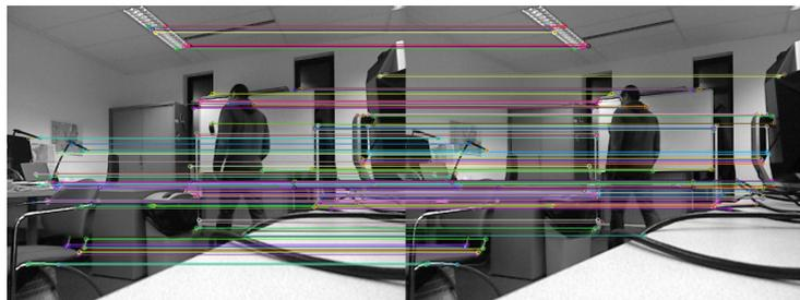
FIGURE 6.3 – Mise en correspondance des pixels entre deux images. Cette correspondance est représentée par les lignes joignant les pixels.
